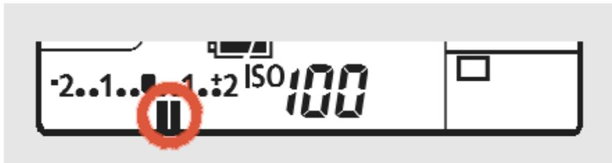
Nella gestione dell'esposimetro interno, bisogna considerare che per convenzione un EV pari a 0 indica un'immagine "esposta" per 1 secondo ad un grado di apertura del diaframma pari a  $f/1$ .
